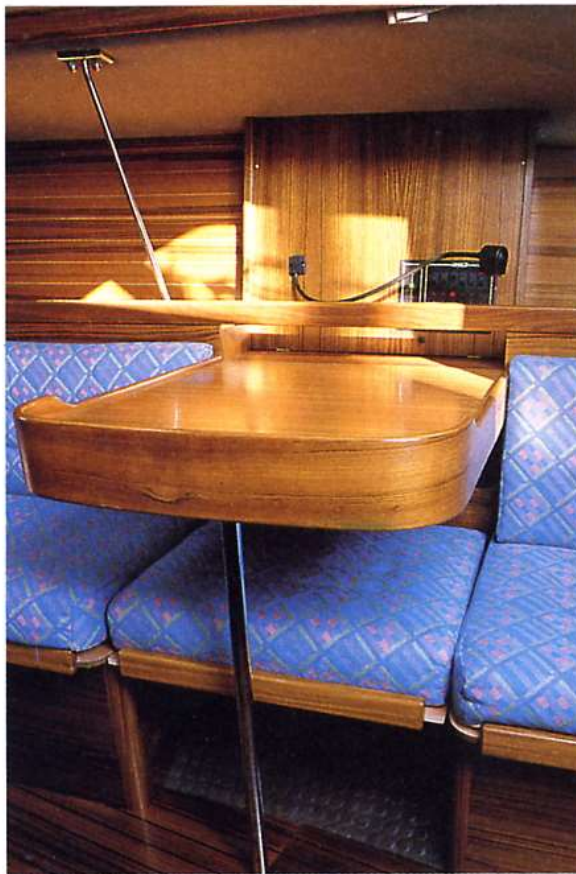
Il particolare tavolo da carteggio, di cui esiste anche una versione smontabile, incernierata. Il divano sottostante è amovibile per far posto alle gambe del navigatore durante l'uso. A murata il pannello portastrumenti.
