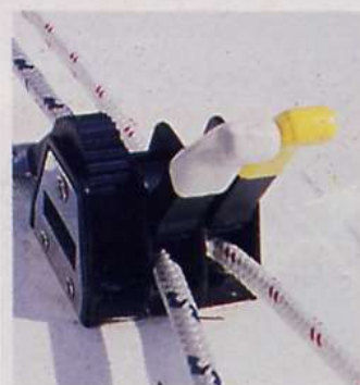
In alto, il winch a due velocità per la regolazione del genoa, con la bitta ad incasso. Sopra gli stopper; per aprirli richiedono l'uso del winch.
