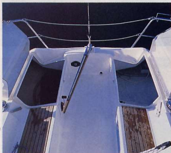
I due gavoni che si aprono in pozzetto.
